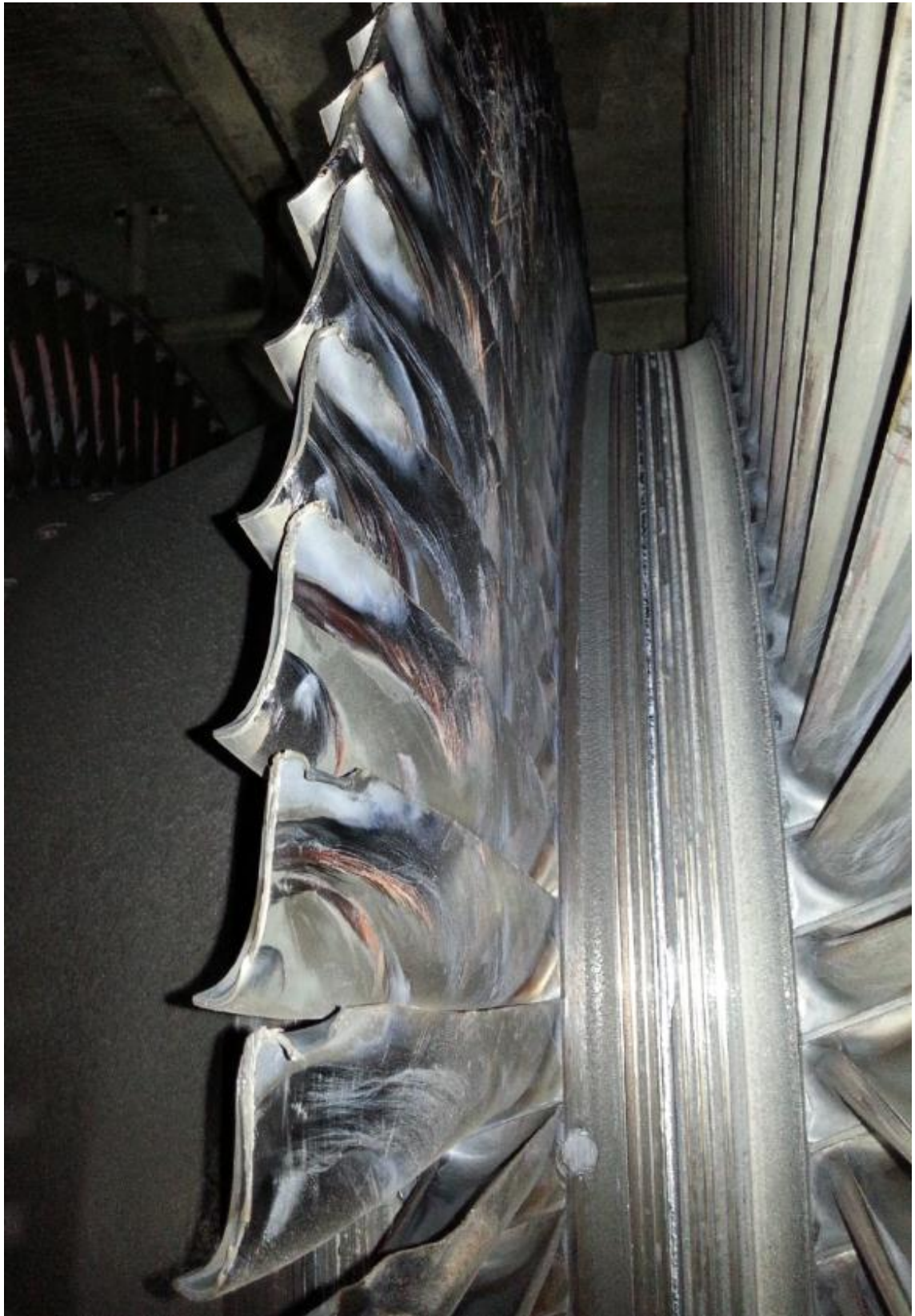
图 11 叶片断裂后对其它部位的损伤的现场照片
