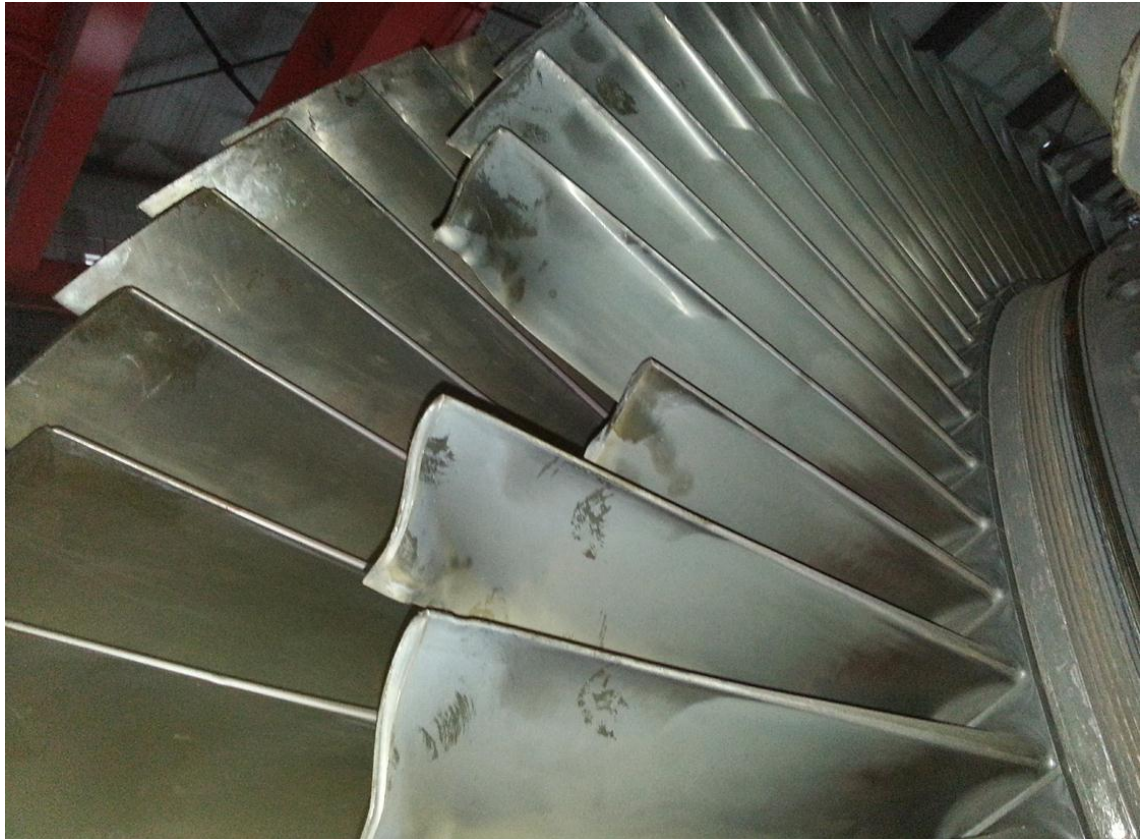
图 8 末 2 级叶片断裂的现场照片
