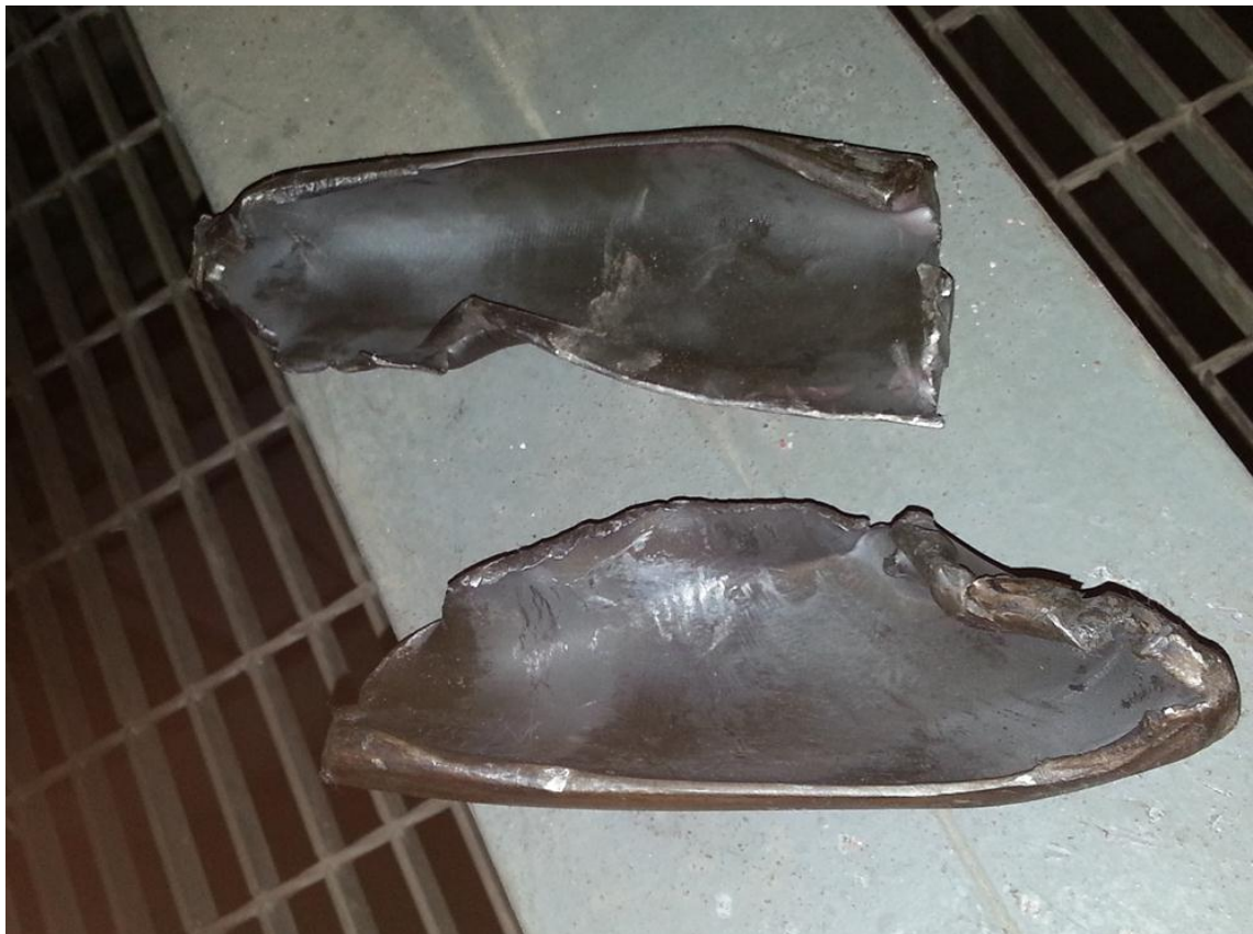
图10 末4级断裂下来的叶片残片的现场照片
