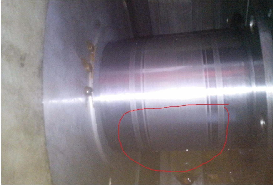
图7 空压机轴颈上的摩擦痕迹
