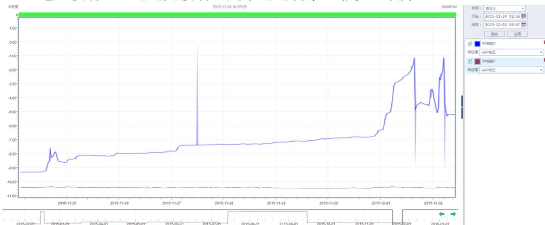
图 4 5#轴瓦 X 通道及 Y 通道的 GAP 电压
