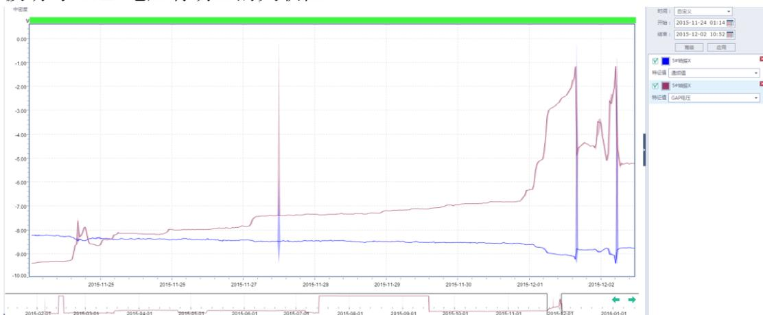
图 3 5#轴瓦 X 通道的通频值与 GAP 电压
