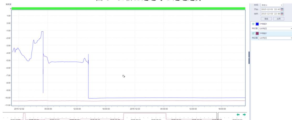
图 6 5#轴 X 通道与 Y 通道 GAP 电压图
