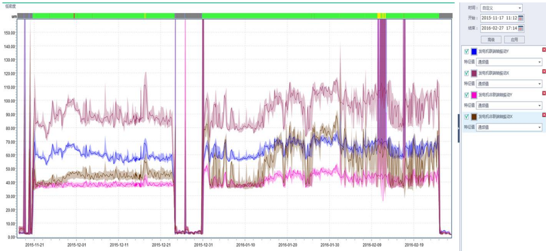
图 4 发电机运行振动波动趋势图
