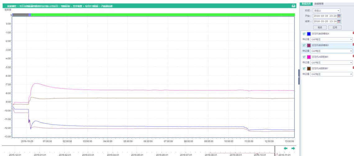
图 3 空压机 A GAP 电压趋势图
