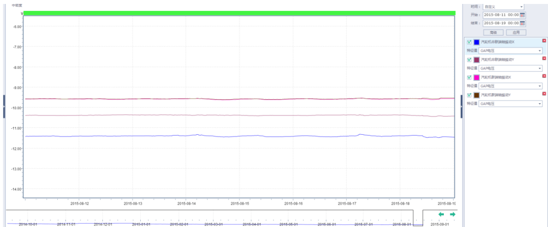
图3 汽轮机 GAP 电压趋势图
